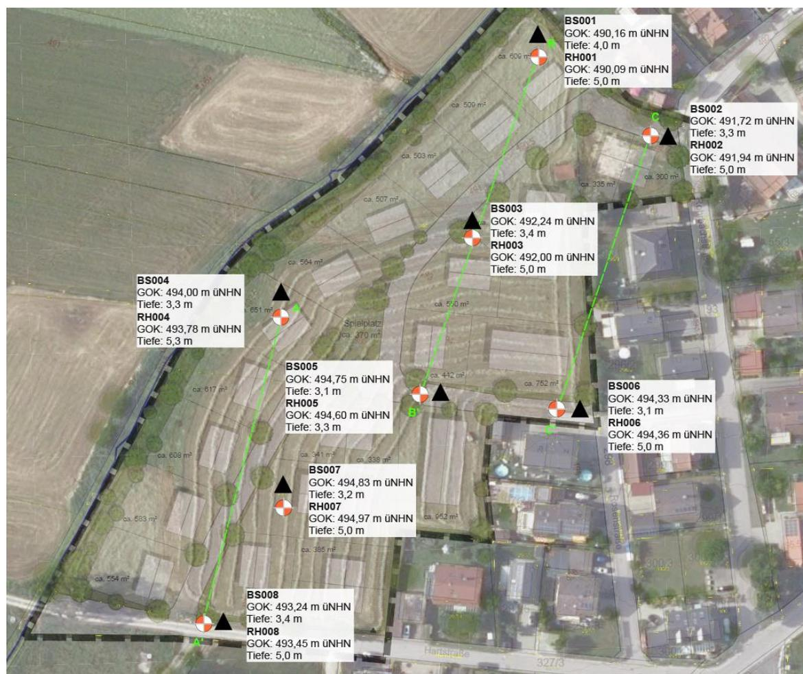
Abbildung 7: Lageplan Bohrsondierungen, Ramsondierungen. Quelle: Büro für angewandte Geowissenschaften test 2 safe AG
