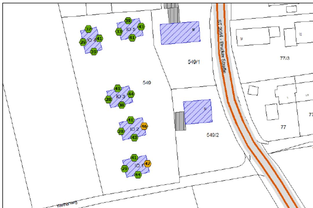
Abb. 8 Ausschnitt aus der Übersichtsgrafik Nachtzeit mit Darstellung der Beurteilungspegel in db(A); Quelle: Schalltechnische Untersuchung (Anlage 1), ohne Maßstab
